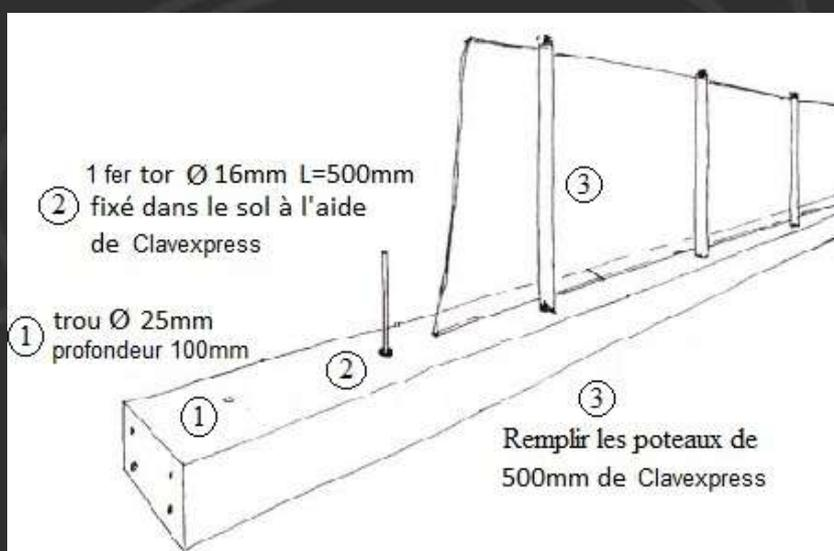
Pour cela, il faut sceller à l'aide de Clavexpress les fers tor Ø16mm de 500mm de long. En zone de vent, tous les 2 ou 3 poteaux, on pourra sceller 2 fers tor espacés de 58mm.
