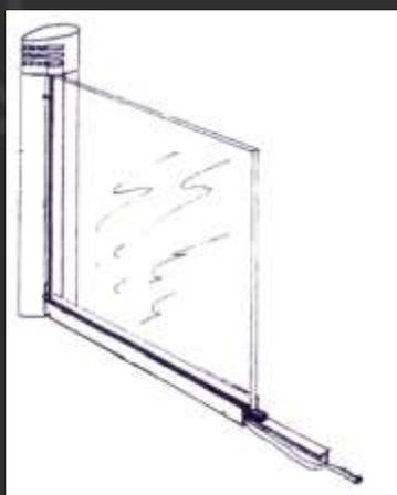
Lors d'un chantier neuf, ou lors de la réfection d'une dalle béton, une gaine pour le passage du câblage électrique est à prévoir.
